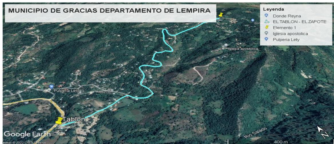
Conformación y colocación de material selecto balastado con espesor de 15cms en superficies de rodadura con una longitud de 2.39 km con ancho promedio de 5.2m. También se realizará el mejoramiento del manejo y canalización de escorrentías pluviales mediante la implementación de nuevas alcantarillas tipo helicoidal de 30” de diámetro en las estaciones 0+380 y 1+430, la primera con una longitud de 6ml y la segunda de 12ml, con cabezales tipo.
