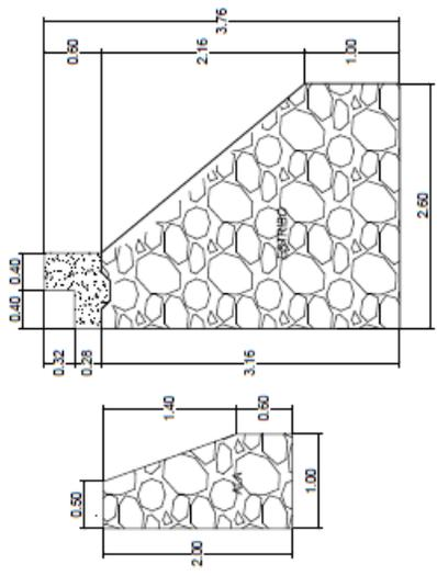
**SECCIÓN DE MUROS EN ESTRIBOS**
