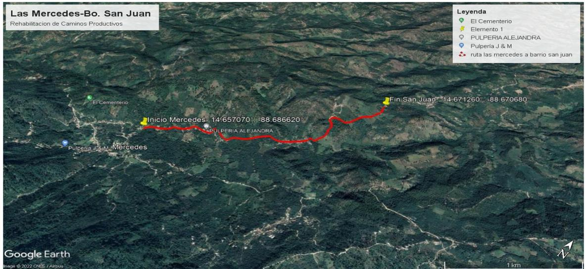
Conformación y colocación de material selecto balastado con espesor de 15cms en superficies de rodadura con una longitud de 3.0 km con ancho promedio de 4.8m. También se realizará el mejoramiento del manejo y canalización de escorrentías pluviales mediante la implementación de nuevas alcantarillas tipo helicoidal de 30” de diámetro en las estaciones 1+200,1+800,2+500,2+900, cada una con una longitud de 6ml, con sus respectivos cabezales.
